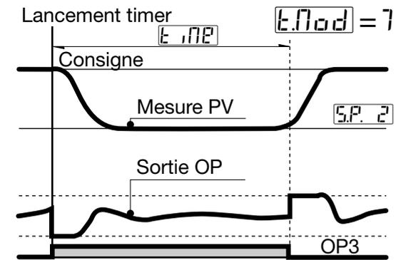
[1] Lorsque le timer n'est pas en cours, la sortie régulation est forcée à 0. Il en est de même avant le lancement.
