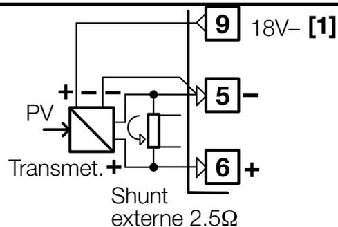
[1] alimentation auxiliaire pour transmetteur 18V- ±20%/30mA max, non protégée contre les courts circuits
