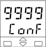
Dans ce cas, les entrées et sorties sont inactives jusqu'à l'insertion d'un code de configuration correct.
