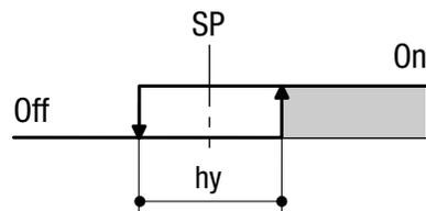
Zone d'hystérésis de la sortie de régulation. Elle est exprimée en % de l'étendue d'échelle.
