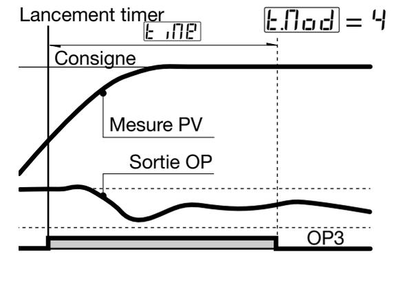
[1] Lorsque le timer n'est pas en cours, la sortie régulation est forcée à 0. Il en est de même avant le lancement.
