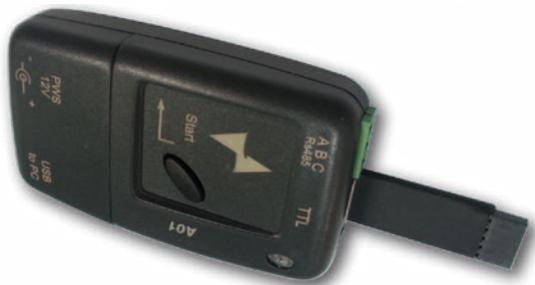
Ce dispositif est utilisable pour la programmation en série d'instruments qui doivent avoir la même configuration des paramètres ou pour conserver une copie de la programmation d'un instrument et pouvoir la transférer de nouveau rapidement.
